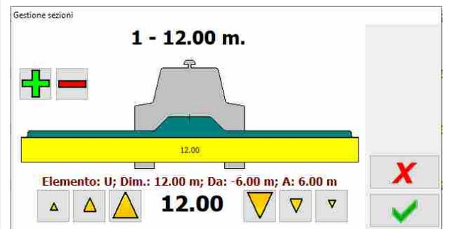
Visualizza la chiusura parziale della barra sezione per sezione.
